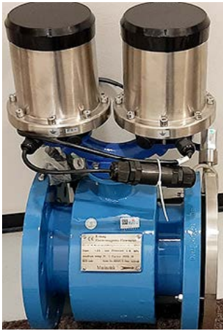
Magneettis-induktiivinen virtausmittari (DN125), johon integroitu myös painemittari.
