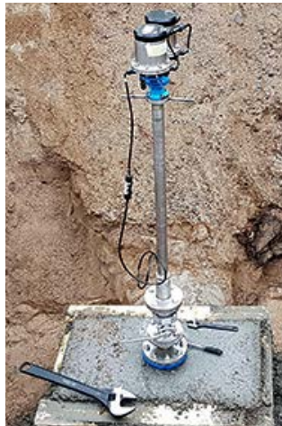
Magneettis-induktiivinen virtausmittaus-sauva DN500.
