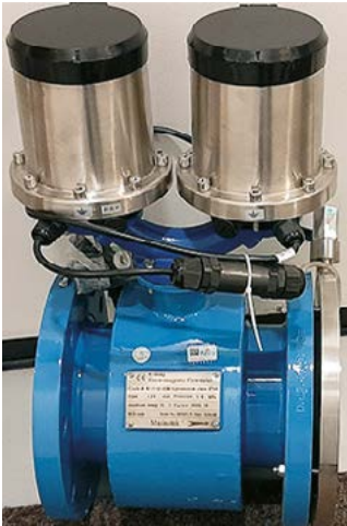
Magneettis-induktiivinen virtausmittari (DN125), johon integroitu myös paineanturi.
