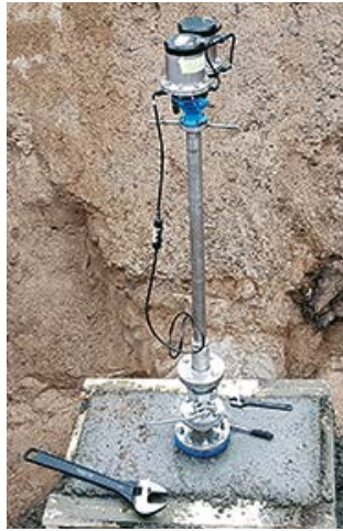
Magneettis-induktiivinen virtausmittaus-sauva DN500.
